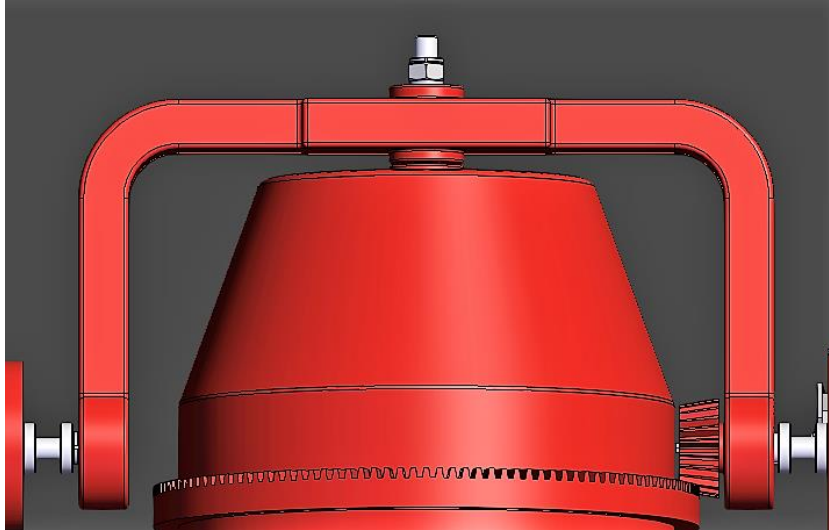
نمای کناری بلبرینگ‌ها و یاتاقان‌های کف‌گرد
